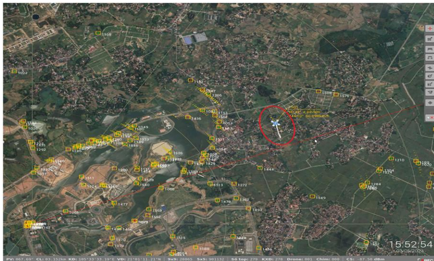
Hình 2-20. Phân loại drone (trong hình elip đỏ) với kịch bản bay theo quỹ đạo tiếp tuyến ở cự ly 2,9 km
