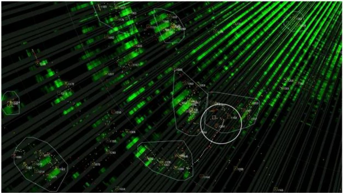
Hình 3-10. Kết quả CFAR giai đoạn 1: mục tiêu thử nghiệm (vòng tròn trắng) và báo động lâm do nhiễu (đa giác)
