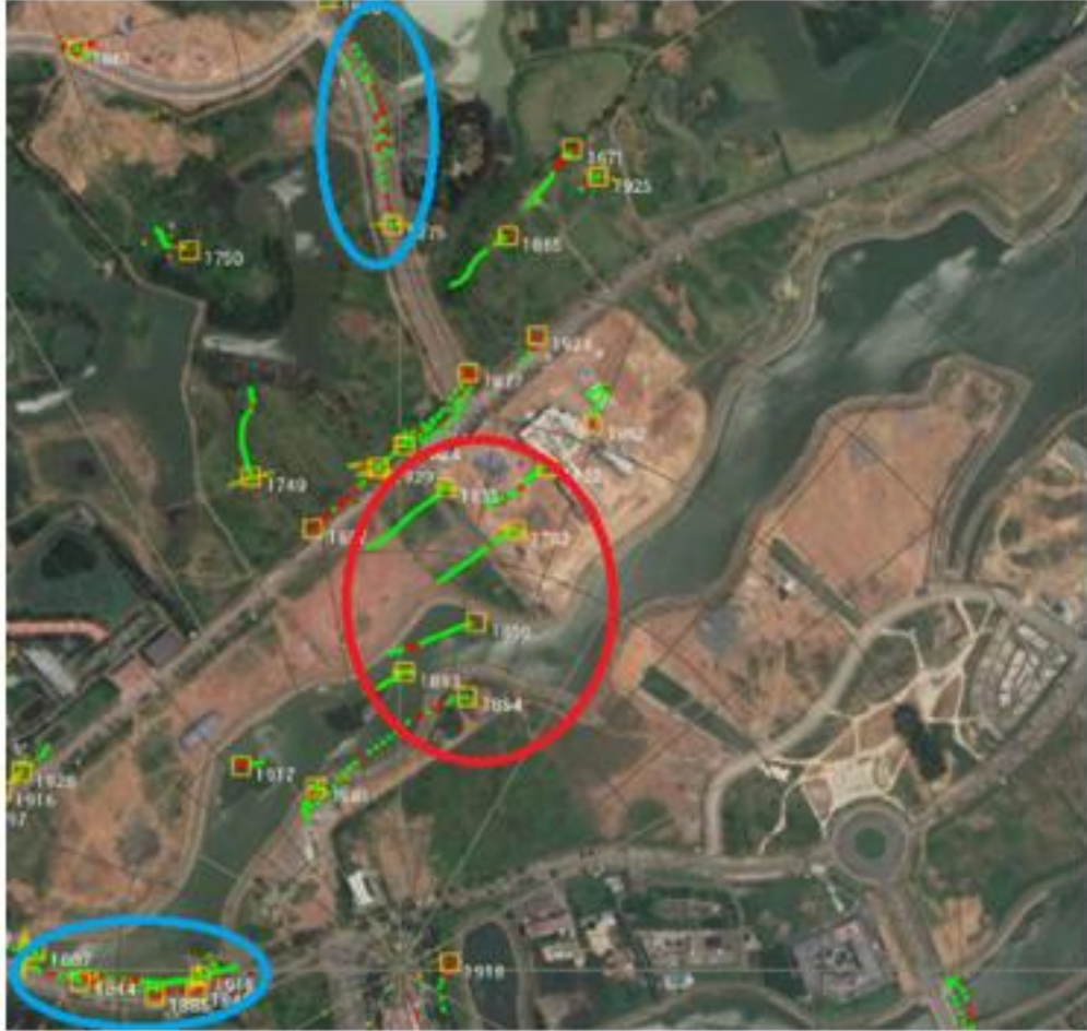
Hình 2-9. Minh hoạ về báo động lầm từ nhiều rời rạc trên đài ra-đa FMCW (chim trong vòng tròn màu đỏ, ô tô trong vòng tròn màu xanh)
